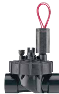
PGV-101JT-G Diametro filetto d'ingresso: 1" (25 mm) Altezza: 14 cm Lunghezza: 11 cm Larghezza: 8 cm
