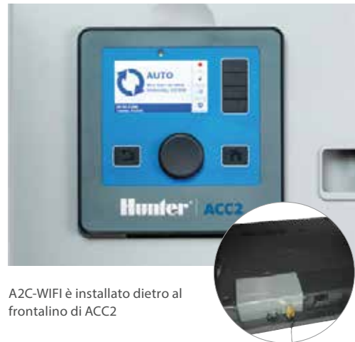
INSTALLAZIONE MODULO DI COMUNICAZIONE ACC2
